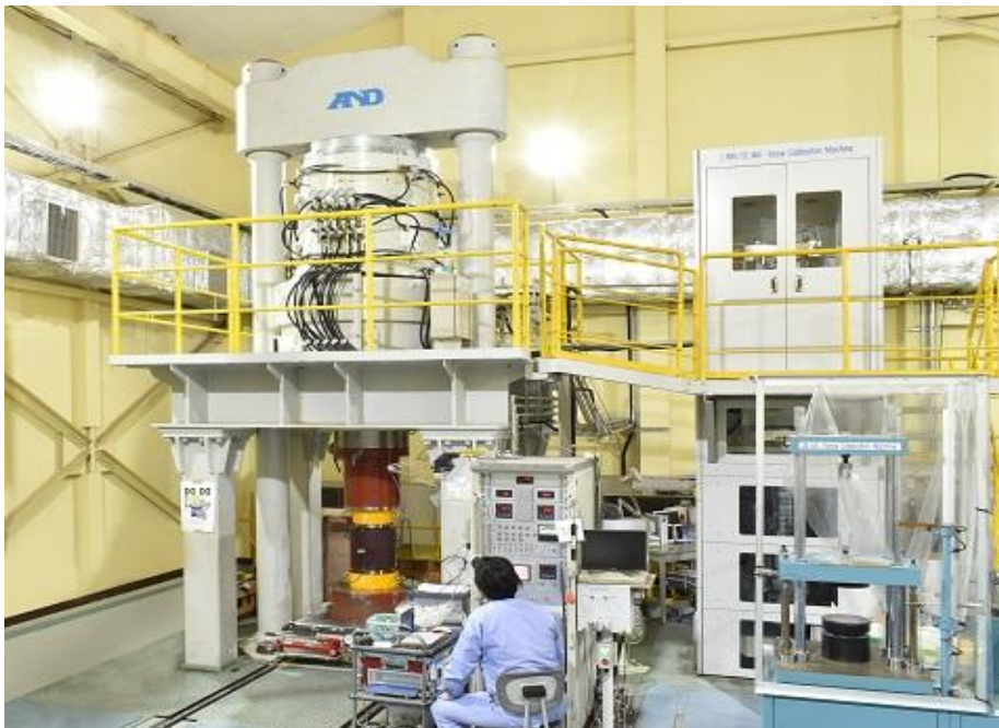
最大圧縮力10 MN（引張力1 MN）まで対応可能な特定二次標準器
