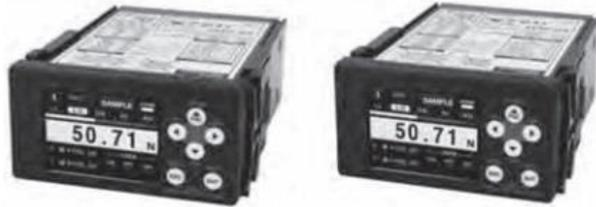
①4000回/秒(ホールド時20000回/秒)の高速処理を実現、②高性能カラーグラフィック液晶画面、③コンパクトサイズ:W96×H53×D132mm(突起物を含まず)、④アナログ電圧/電流出力装備で、レコーダやログの接続が可能、⑤4パターンのメモリ機能、⑥『AD-4533C』はCC-Link接続機種、など。
