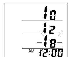
6. SETボタン②をもう1回押すと、時の桁が点滅しますので、裏面の▲ボタン(b)か▼ボタン(c)を押して、時の設定をします。
