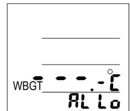
WBGT下限アラームの設定完了もしくは設定しない場合は、SETボタン②を押してください。WBGT上限アラームの設定画面に切り替わります。また、ここでアラーム設定を終わらせたい場合は、通常の画面に戻るまでSETボタン②を3回押してください。アラーム設定が完了します。
