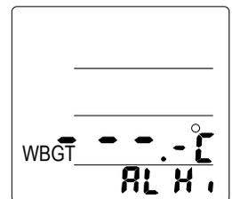
WBGT下限アラームの設定完了もしくは設定しない場合は、SETボタン②を押してください。サンプリング時間の設定画面に切り替わります。また、ここでアラーム設定を終わらせたい場合は、通常の画面に戻るまでSETボタン②を2回押してください。アラーム設定が完了します。
