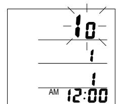
4. SETボタン②をもう1回押すと、月の桁が点滅しますので、裏面の▲ボタン(b)か▼ボタン(c)を押して、月の設定をします。
