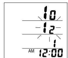
5. SETボタン②をもう1回押すと、日の桁が点滅しますので、裏面の▲ボタン(b)か▼ボタン(c)を押して、日の設定をします。
