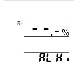
湿度上限アラームの設定完了もしくは設定しない場合は、SETボタン②を押してください。WBGT下限アラームの設定画面に切り替わります。また、ここでアラーム設定を終わらせたい場合は、通常の画面に戻るまでSETボタン②を4回押してください。アラーム設定が完了します。
