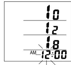
7. SETボタン②をもう1回押すと、分の桁が点滅しますので、裏面の▲ボタン(b)か▼ボタン(c)を押して、分の設定をします。
