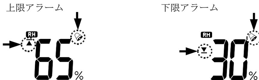
設定した値をクリアする場合には、[MAX/MIN] ボタンを 1 回押してください。表示されている湿度(RH)の上限(下限)アラーム設定値のみがクリアされ、バー表示になります。
