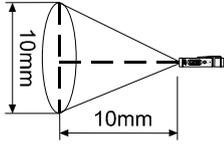
例えば、本器から温度測定する物までの距離を10mmとすると、温度測定範囲は直径10mmの円形になります。温度測定する物がこの円より大きい場合は正しく温度測定できますが、小さい場合、この円の領域をすべて温度測定してしまうため、正しく測定できない場合があります。(小さな部品等の温度測定は誤差が大きくなります)
