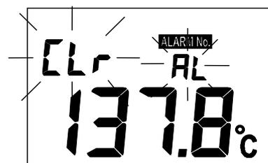
③[CLEAR]ボタンを1回押すと、サブ表示に「[Lr」、ALARM No.に「--」の表示が点滅します。
