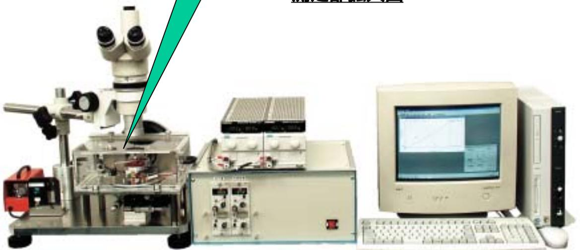
Fig.1 薄膜引張試験装置外観写真
