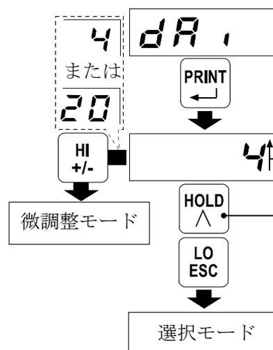
※微調整モードにて出力電流を微調整することができます。
