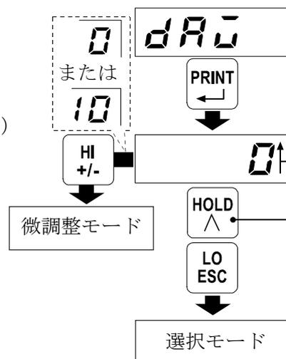
※微調整モードにて出力電圧を微調整することができます。
