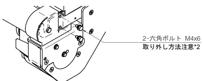
\*1: 六角ボルトを取り外す際、駆動軸受が落下しないように注意してください。
