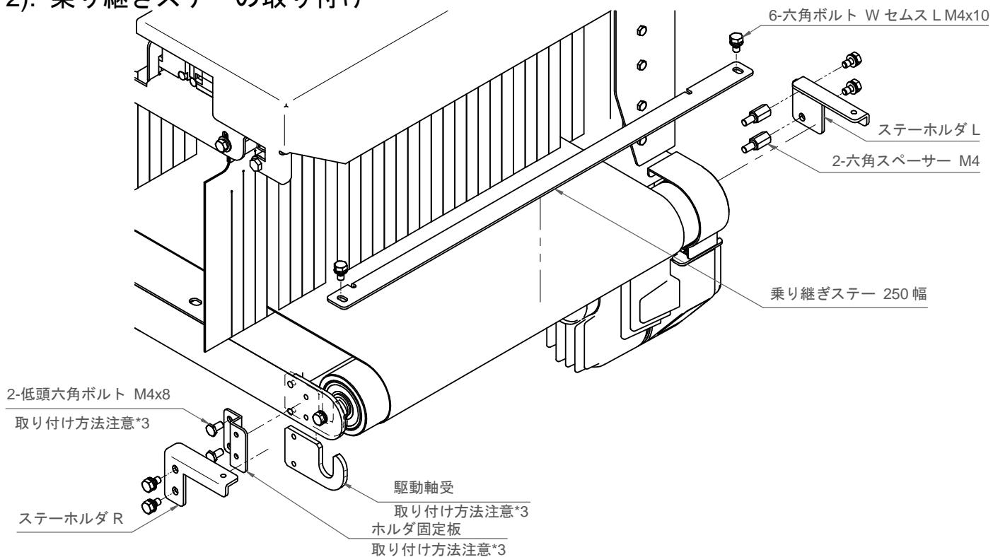
\*3: 駆動軸受をプーリーの軸に押し当てながら低頭六角ボルトを取り付けてください。
