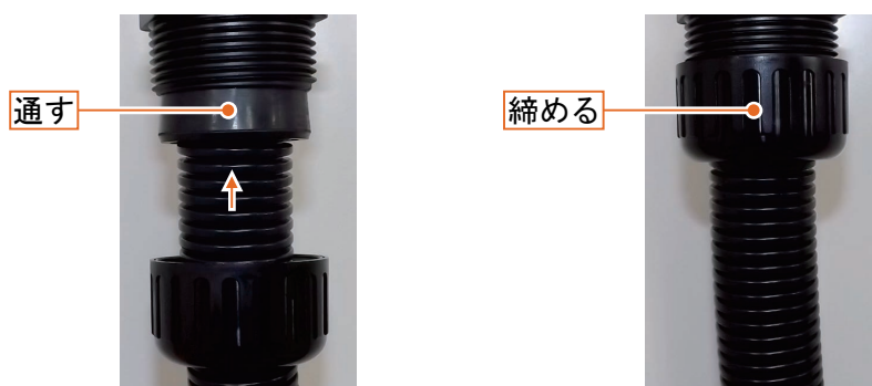
図14 シールナットの締め方
