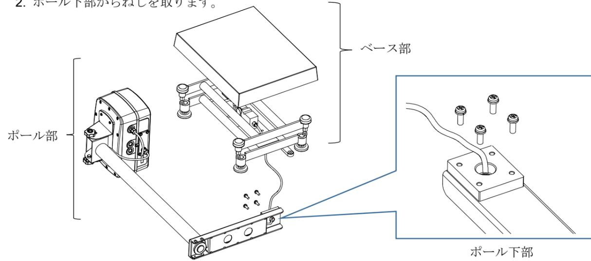
3. 外したネジを使ってポール下部をベースに固定します。
