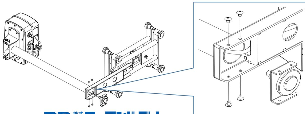
5. 計量部のロードセルケーブルを次の手順で収めてください。この作業を怠ると、ロードセルケーブルが計量皿に触れるなどして正しい計量が出来ません。
