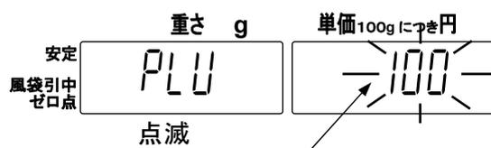
5. **PLU** キーを押すと、ブザーが鳴って（長音）PLUメモリーNo.100に単価を記憶し、ステップ2の表示に戻ります。**C** キーで単価表示をクリア後、テン・キー **1** **0** **0** に引続き **PLU** キーを押して正しい単価が呼び出されることを確認してください。
