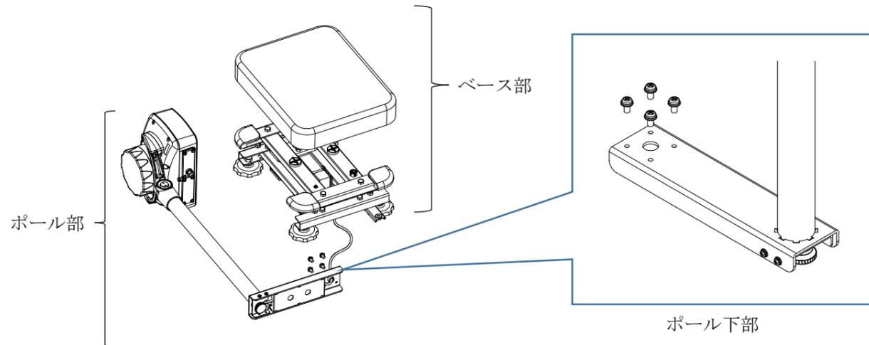
3. 外したネジを使ってポール下部をベースに固定します。
