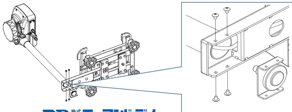
5. 計量部のロードセルケーブルを次の手順で収めてください。この作業を怠ると、ロードセルケーブルが計量皿に触れるなどして正しい計量が出来ません。
