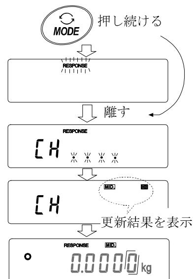
② 自動的に天びんの動作点検を開始し、また、自動で応答特性を設定します。
