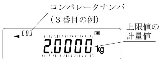
④ 次のキー操作で使用するコンパレータナンバを選択してください。
