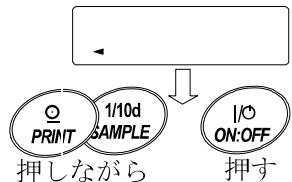
② **PRINT**と**SAMPLE**キーを押しながら**ON:OFF**キーを押すと **P5** を表示します。
