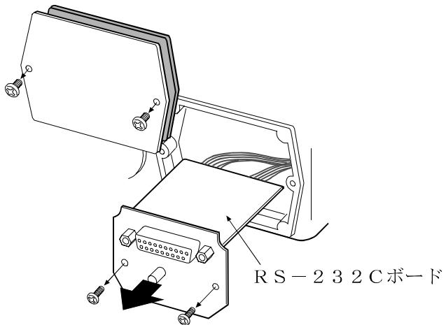
2. RS-232Cボードを反転させコネクタを上にむけます。ボードからコネクタを外します。(固いので注意してください。)
