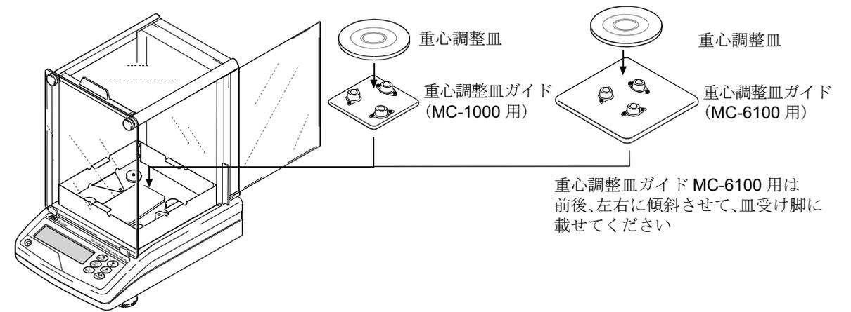
注意 計量皿を重心調整皿に変更したときは、重さが変わりますので使用前に内蔵分銅または外部分銅による校正を行ってください。
