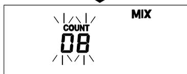
[ 6 ] ⬇ Up/Down キーで混合時に吸引する容量を設定します。
