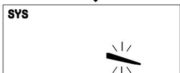
[6] ⬆ Up/Down キーでリバース動作モードのオン
