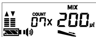
[2] ピペット本体の
