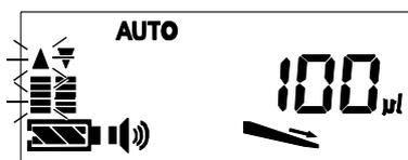
[1] チップの先端を液体に入れ、ピペット本体の
