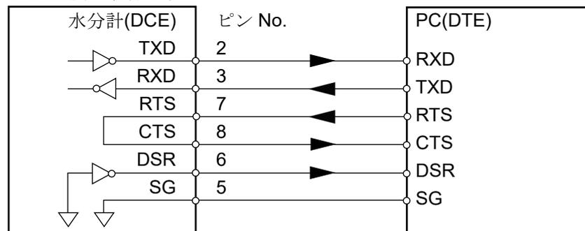
※1 エー・アンド・デイ製の一部の周辺機器で使用します。他社製品で電源が出力されている機器と接続する場合は、結線しないでください。誤った接続ケーブルを使用すると機器を壊す場合がありますので、必ず適合ケーブルを確認してください。
