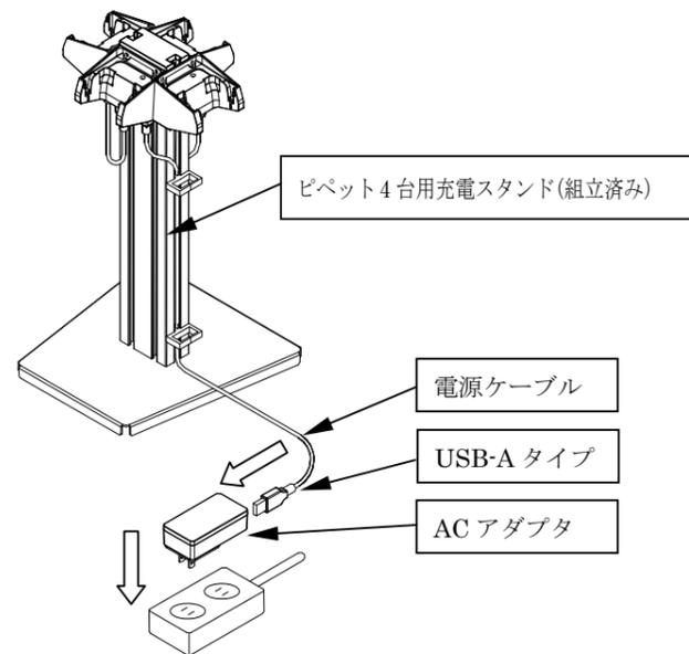
4. PA/PB を充電部に掛けることで充電が開始されます。充電中は、PA/PB の表示部画面左下の電池マークが図のように点滅し続けます。
