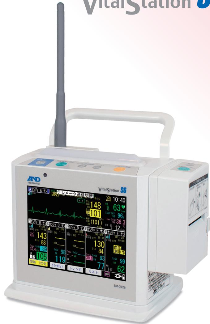
本装置は、特定小電力無線を介し、離れた場所の患者のバイタルサイン(患者の心電図波形、心拍数、呼吸数、非観血圧値、SpO<sub>2</sub>、体温、RPP/SIなど)を監視することができ、最大6人の患者をモニタリングすることが可能です。また、バッテリーユニット(TM2590-12)を装着することにより、電源の無い場所での稼働が可能となります。
