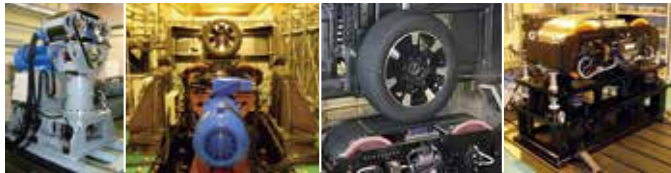
上下&ステア方向加振機能を備えたムービングベルト装置の実施例 ベルト駆動基本ユニット
