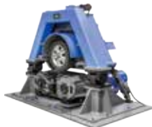
名古屋大学殿向け 小型タイヤ用ベルト試験機
