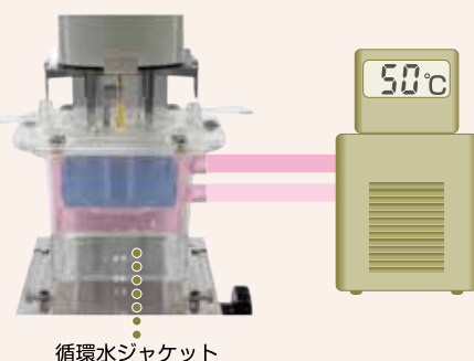
循環水ジャケット
